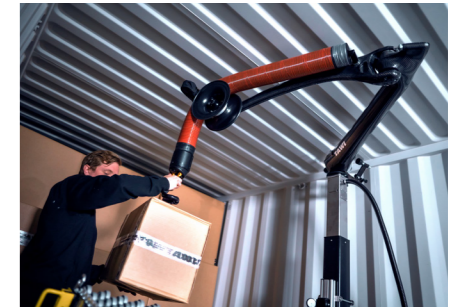
Bras articulé à faible hauteur en acier ou en carbone avec une portée en hauteur de 2,1 m à 2,6 m
