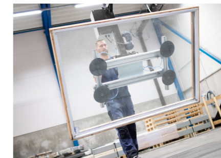
Le nombre de ventouses est adapté à votre charge afin que l'outil soit toujours adapté pour vos besoins de levage. La fonction de libération à deux mains garantit une prise et une libération de la charge sûres et faciles.
