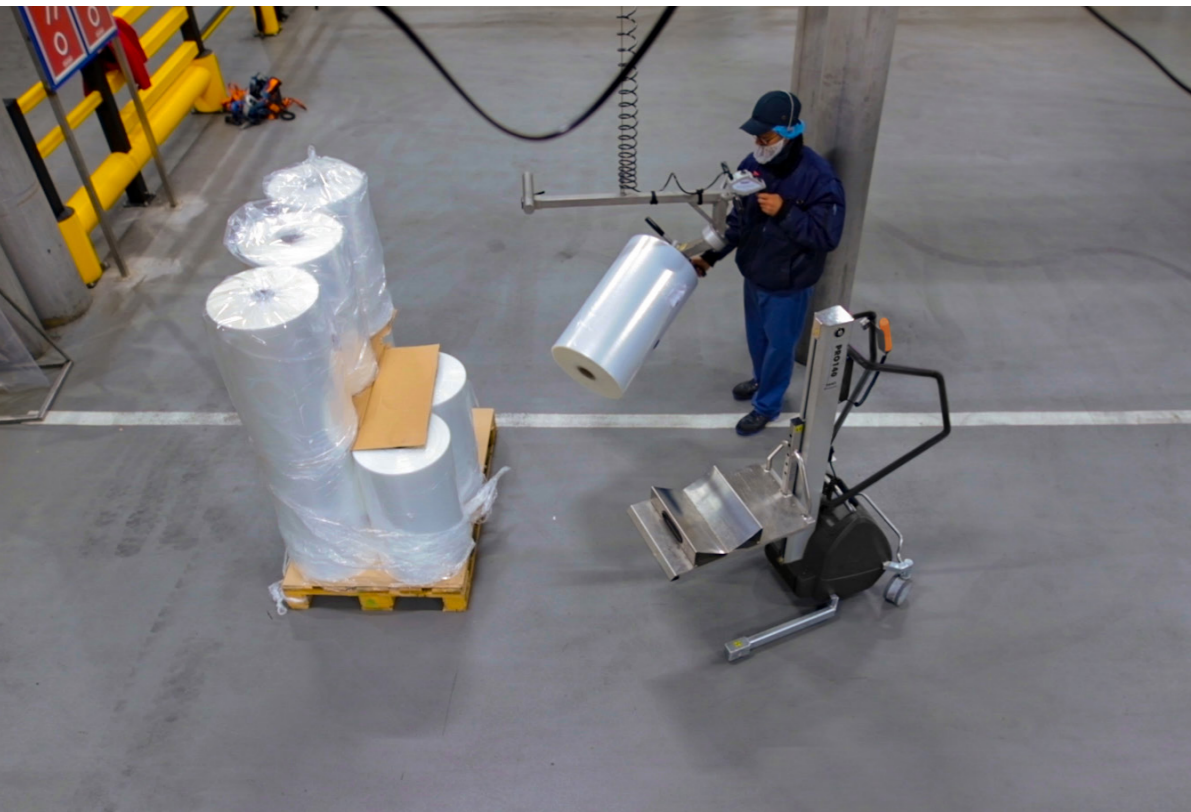
Les palans peuvent être facilement combinés avec d'autres solutions de levage TAWI. Ici, le palan à câble est utilisé pour soulever de lourds rouleaux de film depuis une palette, les incliner, puis les placer sur un chariot portable. Le chariot est ensuite utilisé pour transporter et monter les rouleaux dans des machines d'emballage.
