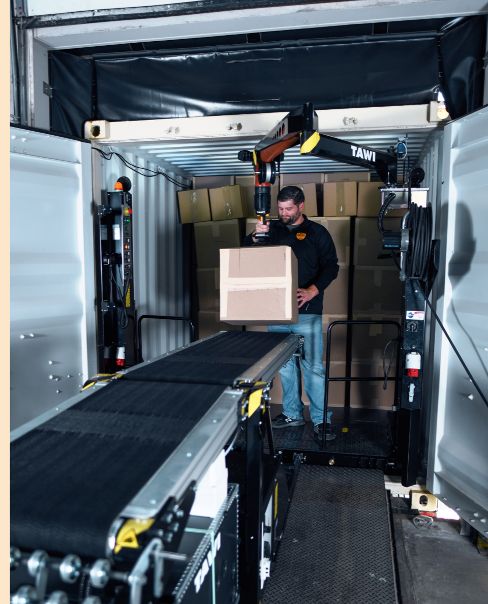
Le déchargeur/chargeur de conteneurs dispose d'un système stabilisé avec un équilibrage intégré pour aider lors des déplacements sur des pentes.
