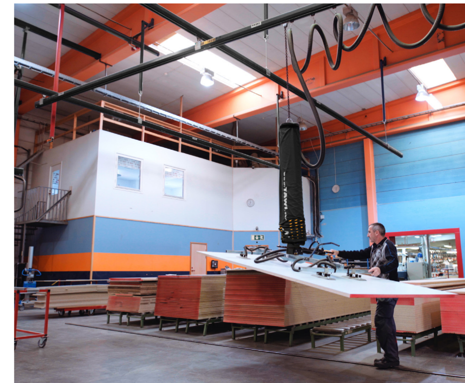
Les Potences TAWI peuvent être montées sur un mur ou un pilier, et des options portables sont disponibles.
