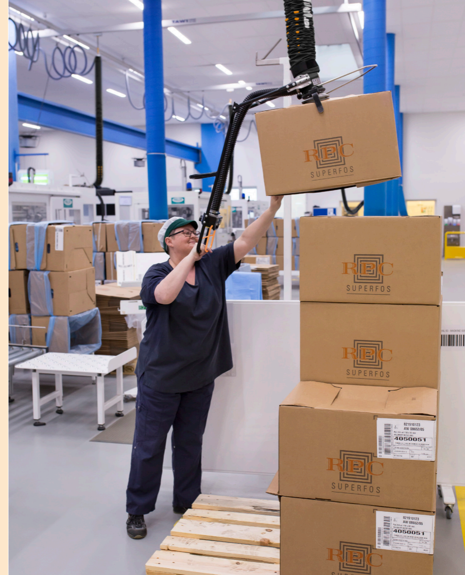
Soulever au-dessus des épaules est facile et sans effort avec notre appareil de levage par le vide.
