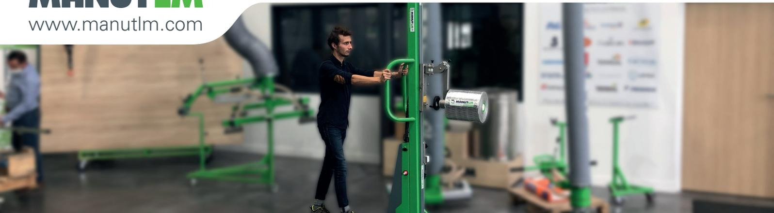
La gamme de Gerbeurs de Manutention GM-Bobines de 80 à 600 kg est une solution mobile permettant de faciliter la palettisation, dépalettisation et la mise en machine de tous formats de bobines
