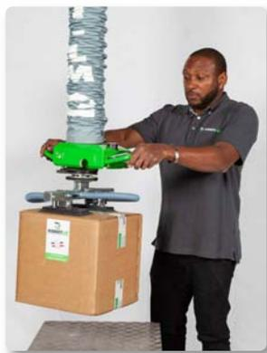
D'un point de vue technique, **EASY Fast** a été conçu pour lever des cartons, sacs, bidons, ..., allant jusqu'à 50 kg sans que l'opérateur ne soit affecté en termes de poids de charge, d'habitudes de travail ou de cadences.
