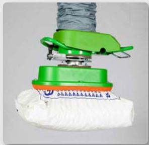
Au delà de sa fonction multi-tâches, **EASY Fast** se révèle être l'outil idéal pour le levage et la manutention de tout type de sacs en agroalimentaire.
